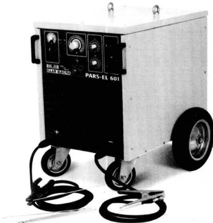
شکل ۱ - ۴ تجهیزات جوشکاری دستی شامل مولد، کابل اتصال بهفلز پایه، کابل انبر، انبر و الکترود روکش دار.
