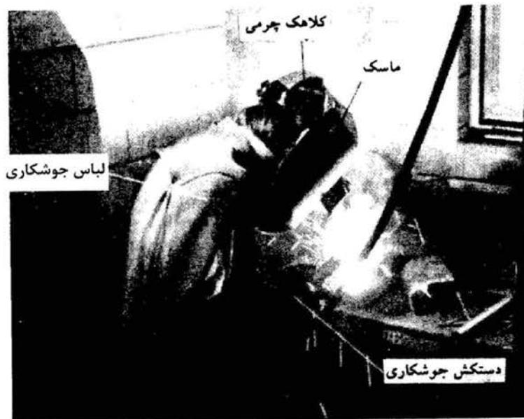
شکل ۲-۲۱ یک کارآموز جوشکاری با لباس محافظ مناسب.
