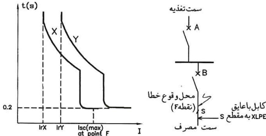
(۱) اختصاص منحنی به کلیدها بستگی به جریان نامی کلیدهای A و B دارد.
