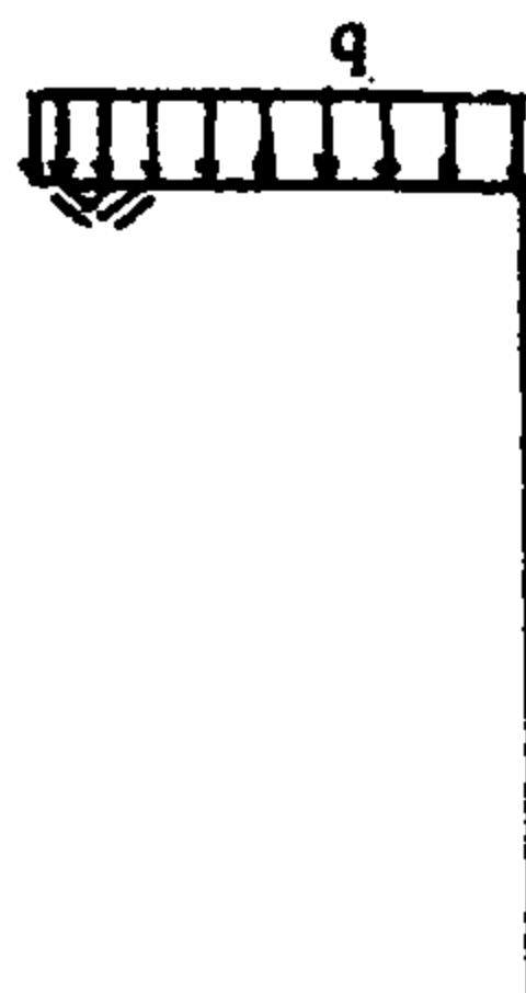
شکل ۲-۱- دیواره قائم خاکی، همراه با سربار وارد بر آن
