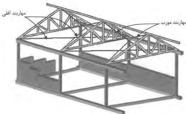
شکل ۳۰-۷ تعبیه مهاربندهای فائمه و افقی در خرپاها
