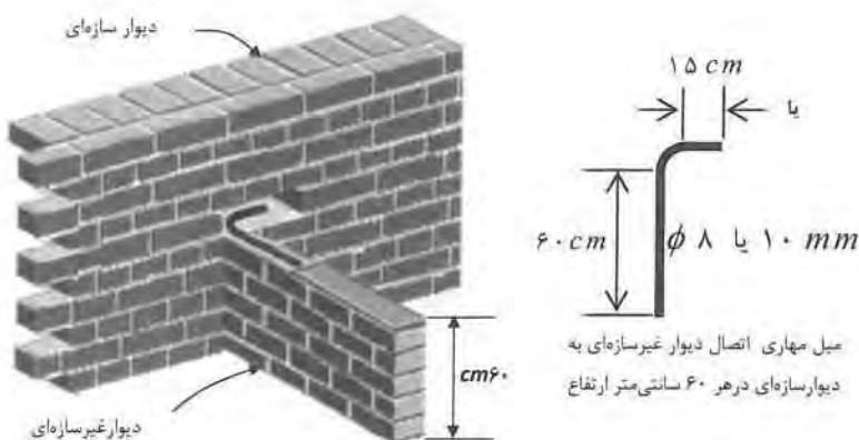
شکل ۱۵-۷ نحوه قفل و بست دیوار غیرسازه‌ای به دیوار سازه‌ای
