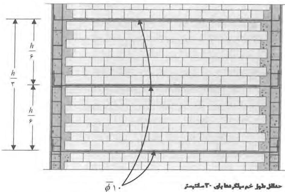
شکل ۱۳-۷ نحوه تعیینه میلگرددهای ناحیه یک سوم میانی ارتفاع دیوار ( $h$ ) و اتصال به کلاف قائم
